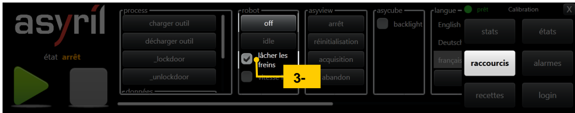
Figure 6-7 : Procédure de lâché des freins
